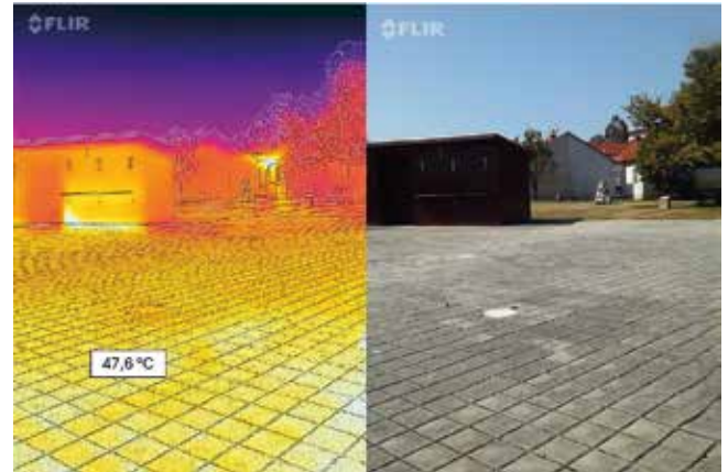
Rathausplatz Ebreichsdorf: oben: 47,6 °C Oberflächentemperatur in der Mitte des Marktplatzes unten: Dank Schattenwurf, unversiegeltem Boden und Nähe zum Wasser nur 29,4 °C bei der kleinen Brücke
